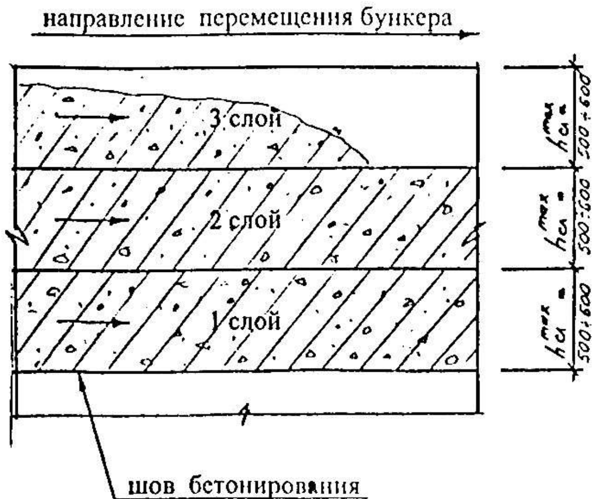
Рис.2. Схема послойного бетонирования
