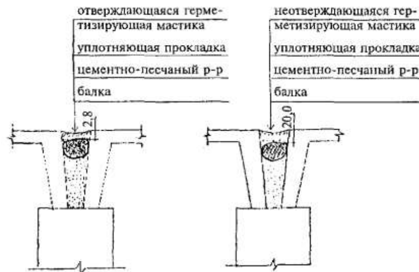
Рис. 1. Конструктивные решения герметизации швов кровельных плит
